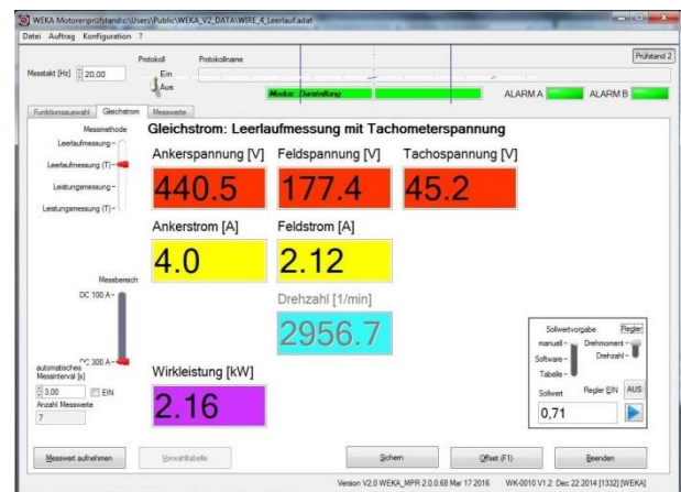
Anzeigefenster Gleichstrom Messmethode Leerlaufmessung
